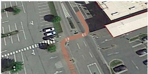
Beispielhafte Darstellung für die Markierung eines roten Radstreifens (Maßnahme Nr. 163) einerseits und der klaren Kennzeichnung einer Fahrradquerung. Alternative Bodenmarkierungen für Radfahrerquerungen sind Blockmarkierungen neben bestehenden Fußgängerquerungen. (Google Maps, 2023)
